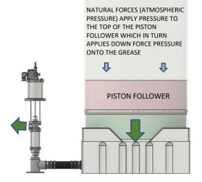
GREASE IS PUMPED INTO THE TANK
